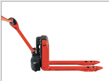
Timon long à accroche basse assurant une distance de sécurité entre l'opérateur et le chariot
