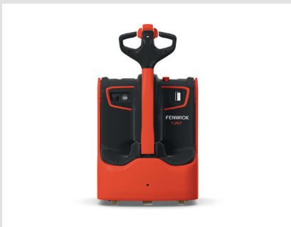
Tête de timon ergonomique avec commandes intuitives
