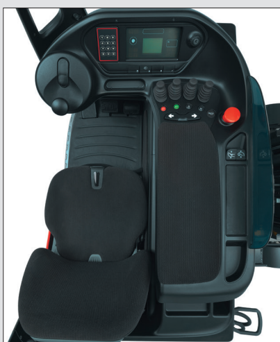
Poste de conduite ajustable
