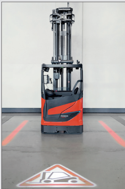
Chariot équipé de TruckSpot et RedLines
