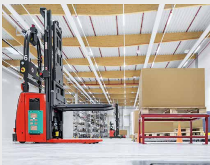
Contrôle de charge innovante par caméra 3D (sur version HD)
